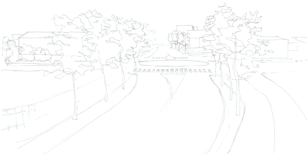
Enkel skiss på ny utformning av trafikplatsen med rondell och avsmalnande körfält. Trädplantering längs sidorna och gc-väg på östra sidan Hamnbron.
